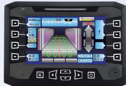
スクリュ・コンベヤ搬送状態
